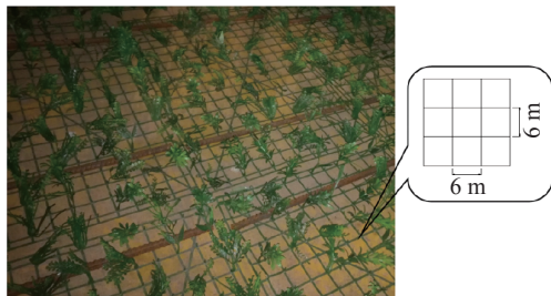
图3 塑料树6 m×6 m排列照片
