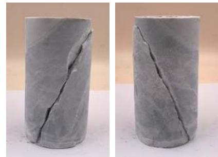
图 6 锦屏大理岩三轴压缩破坏形态
