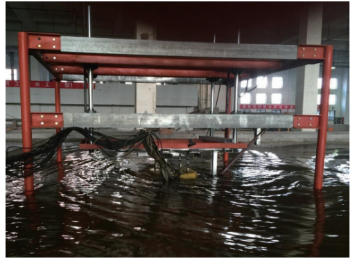
图 4 物模缩尺水槽试验
