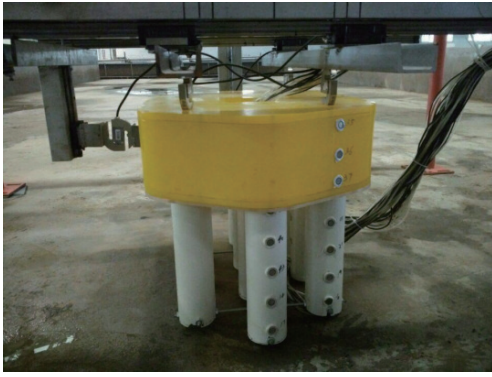
图 3 模型测点布置
