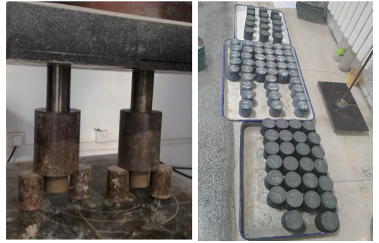
图1 压力模具成型过程及成型的抗压试块
